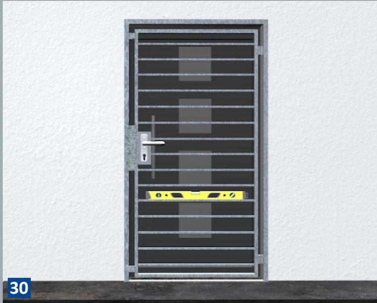
**30** Danach stecken Sie umlaufend jede Schraube durch die Bohrlöcher der Befestigungslaschen der Gittertür in die Dübel und drehen diese kurz mit der Hand im Uhrzeigersinn in den Dübel ein. Wenn alle Schrauben der Tür vorbereitet sind wird die Wasserwaage zum Ausrichten der Gittertür angelegt und nachkontrolliert.
